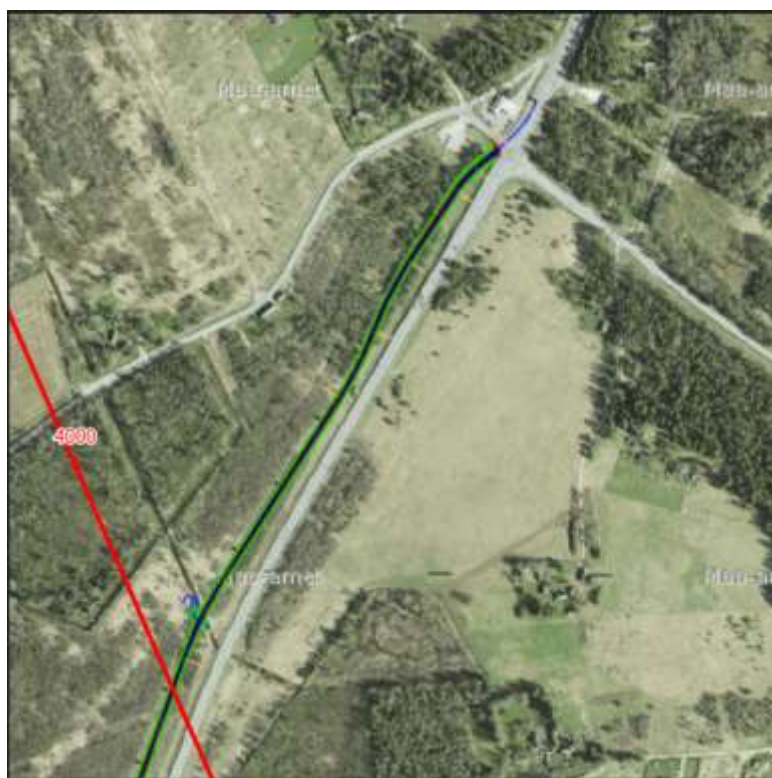
Joonis 5. Rajatud ajutine tee tugimaantee nr 15 sulgemise võimaldamiseks. Punase joonega tähistatud RB raudtee.
